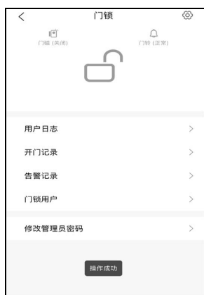
图8 手机 App 远程控制智能门锁开启
